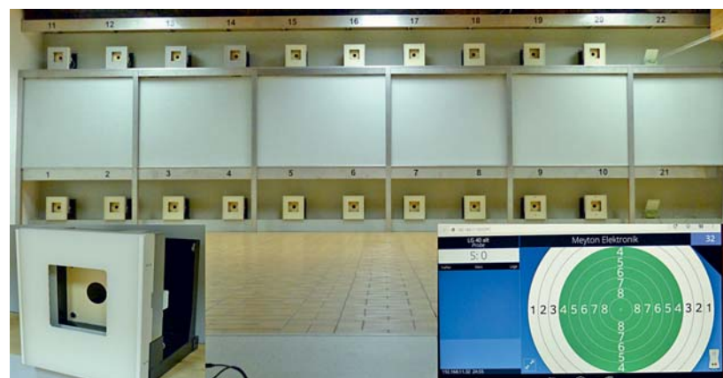
10-m-Anlage für Luftdruck mit 20 elektronischen Ständen. Vergrößert eingebildet links Messrahmen mit vorgesetztem Beleuchtungsrahmen, rechts Trefferanzeige auf Tablet-PC am Schießstand.
