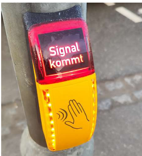
Anforderungseinrichtung ohne Berührung auslösbar und Druckknopf an Unterseite um Orientierungssignalgeber auszulösen
