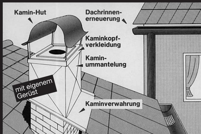
Das Diagramm zeigt die verschiedenen Bauteile einer Kaminanlage und der Dachrinne. Beschriftungen umfassen: Kamin-Hut, Dachrinnen-erneuerung, Kaminkopf-Verkleidung, Kamin-ummantelung, Kaminverwahrung und ein Gerüst mit der Aufschrift 'mit eigenem Gerüst'.
